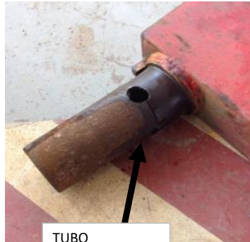
TUBO FRACTURADO
